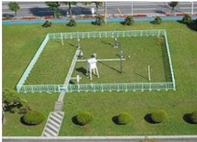
度・風向・風速・降水量・降雪の深さ・積雪の深さ・日照時間・日射量を観測しています。また、職員の目視により、降雨や降雪・雷・霧などの大気現象、雲の量や種類、視程の観測を行っています。江差特別地域気象観測所では、地上気象観測装置による自動観測を行っています。
